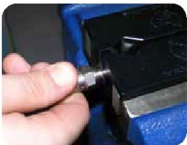
**Passaggio 4:** Posizionare le ganasce in ergal nella morsa, stringere il raccordo e lubrificare la filettatura con un po' d'olio. Ora spingere il tubo sul raccordo, ci sarà una leggera resistenza.
