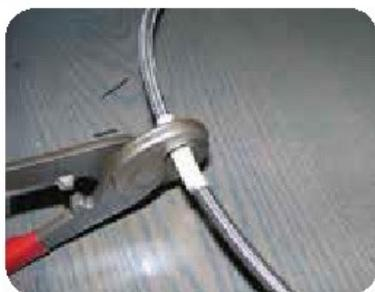
**Passaggio 1:** Selezionare la dimensione del tubo corretta per i raccordi e misurare la lunghezza desiderata (tagliare il tubo con il flessibile o con tronchesi specifiche). Controllare che il taglio sia uniforme e che ogni residuo sia rimosso (il taglio deve essere il più pulito possibile).
