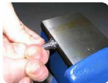
**Passaggio 3:** Prendere l'ogiva ed inserire l'estremità conica tra il tubo in Teflon e la treccia metallica. E' molto importante che non rimangono fili metallici sotto l'ogiva, perché altrimenti causerebbero perdite! A questo punto spingere l'ogiva nel tubo contro il lato della morsa oppure contro una superficie piatta e dura. Controllare che il tubo interno sia alloggiato e centrato sullo scalino interno dell'ogiva.
